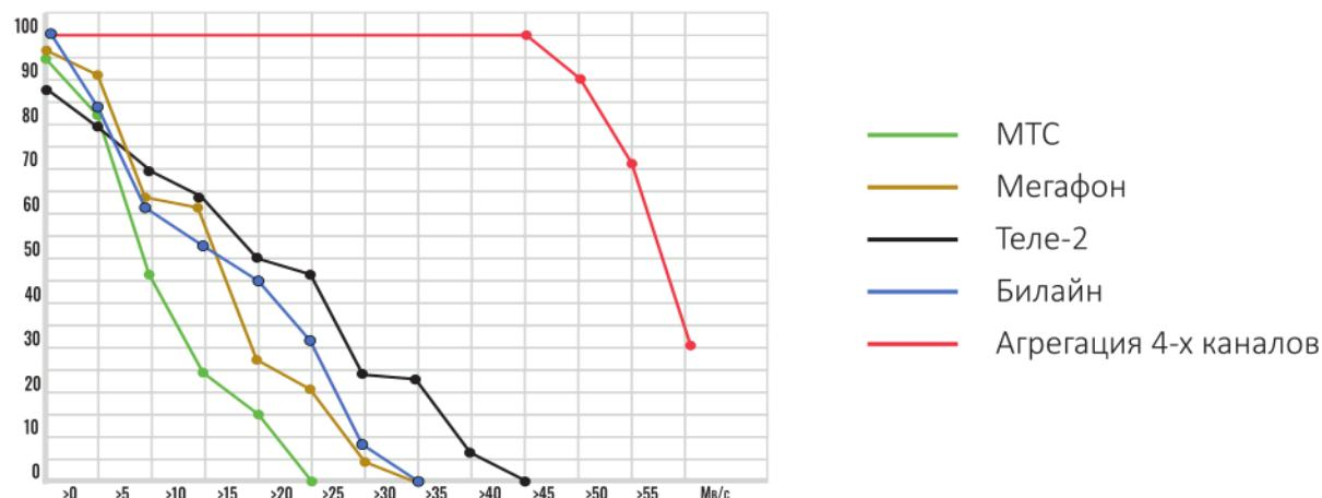
Агрегация каналов связи позволяет получить качественное улучшение надежности связи и скорости приемо-передачи информации на транспорте.
